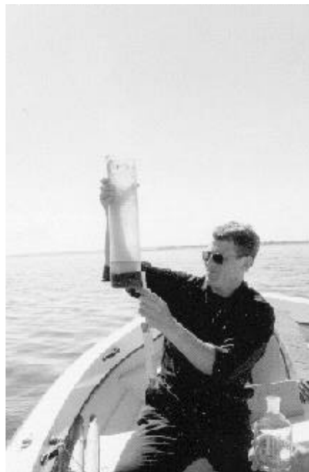
Fig. 3. Uppmätning av mäktigheten på, i sedimentfällan, insamlat sediment (Foto Bo Juhlin 1997).
